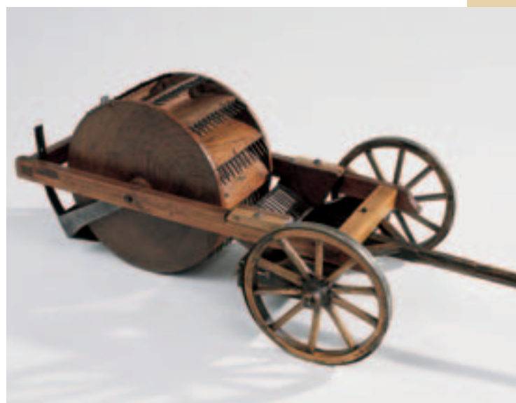
Modello originale per la realizzazione della cavasassi, macchina ideata da Galvani per togliere i sassi dai campi coltivati
