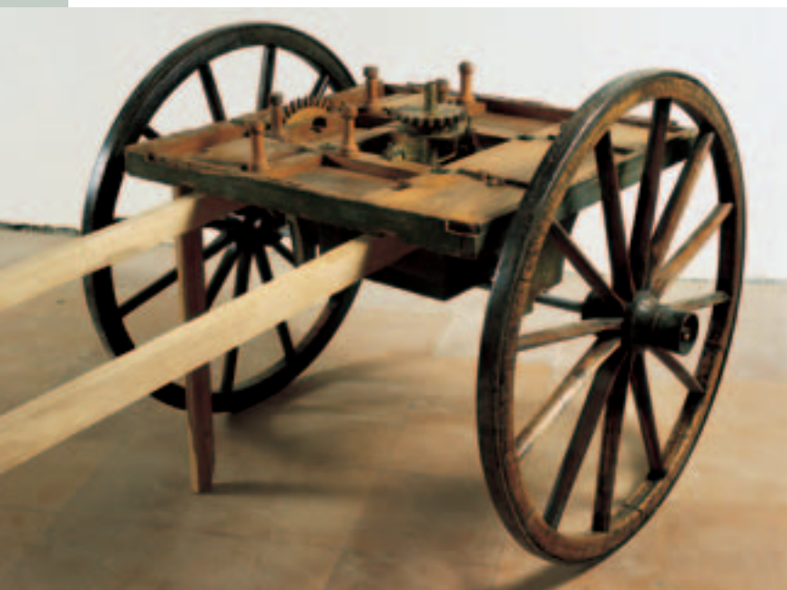
Modello originale per la realizzazione dell'odometro, dispositivo ideato da Galvani per la tracciatura automatica e in scala di un percorso
